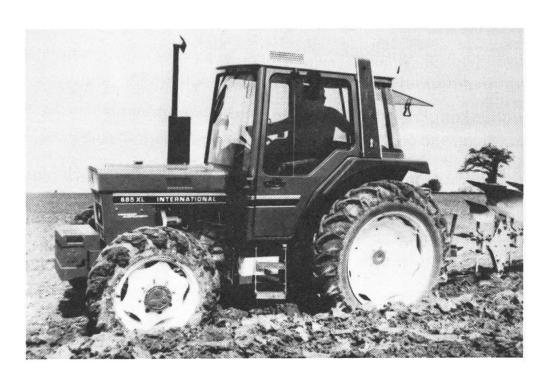
Abb 1: IH-Traktor 585 XL, Allradantrieb, 43 kW/58 PS. (Werkfoto)
