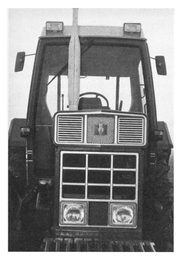
Abb. 2: Eiförmige Kabine hilft Lärmpegel senken. (Foto: d.r.)
