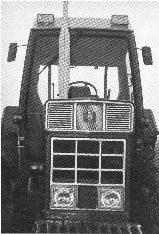
Abb. 2: Eiförmige Kabine hilft Lärmpegel senken. (Foto: d.r.)
