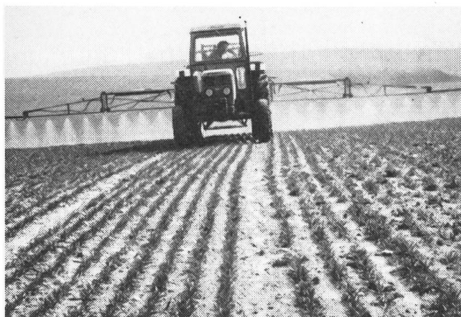
Abb. 1: Spritze beim Ausbringen von Flüssigdünger.
