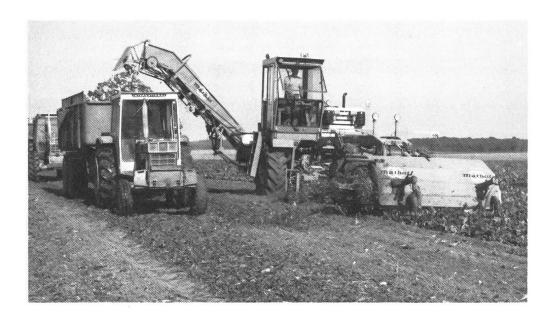
Abb. 6: Selbstfahrender, sechsreihiger Köpfroder.
