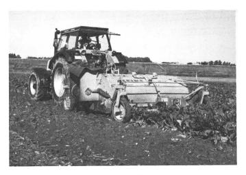
Abb. 3 + 4: Zweiphasiges Erntesystem (Sechsreihiger Köpfroder und Ladegerät).
