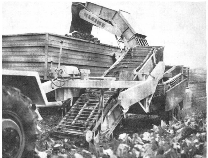
Abb. 3 + 4: Zweiphasiges Erntesystem (Sechsstreihiger Köpfröder und Ladegerät).
