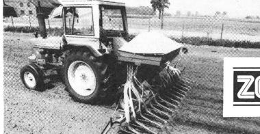
ACCORD Pneumatic Sämaschine einfache Einstellung, Saatmenge von 2 – 360 kg/ha, für Grob- und Feinsaat, höchste Dosiergenauigkeit durch ein Zellenrad, geringe Rüstzeiten, grosse Flächenleistung, Reihen- und Bandsaat (8 cm).
