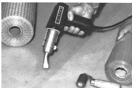
LEISTER beim Verschweissen von PVC- und Polyäthylen-Folien.
