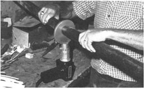
LEISTER beim Stumpfschweissen von Polyäthylen-Rohren.
