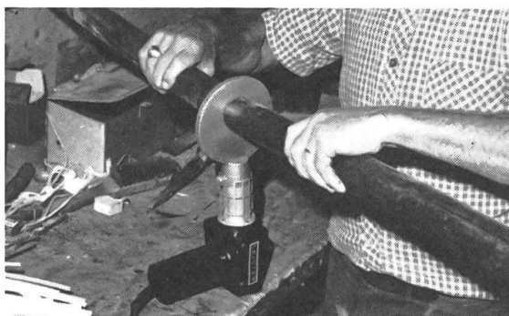
LEISTER beim Stumpfschweissen von Polyäthylen-Rohren.
