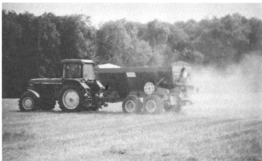
Abb. 1: Die Verteilung des entwässerten Klärschlammes erfolgt mit einem traktorgezogenen Grossflächenstreuer.
