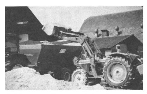
Abb. 2: Der entwässerte Klärschlamm kann über längere Zeit gelagert werden. Das Verladen auf den Streuer erfolgt mit dem Frontlader.
