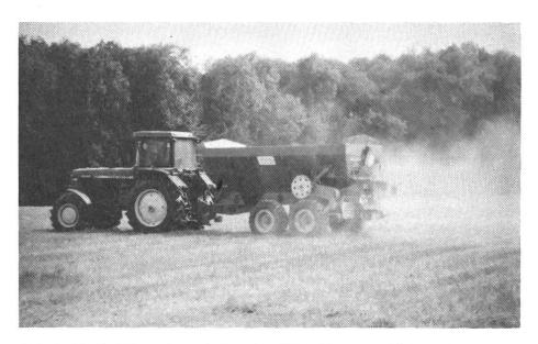
Abb. 1: Die Verteilung des entwässerten Klärschlamms erfolgt mit einem traktorgezogenen Grossflächenstreuer.
