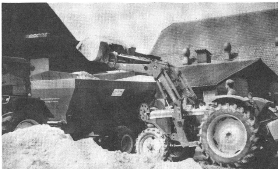
Abb. 2: Der entwässerte Klärschlamm kann über längere Zeit gelagert werden. Das Verladen auf den Streuer erfolgt mit dem Frontlader.
