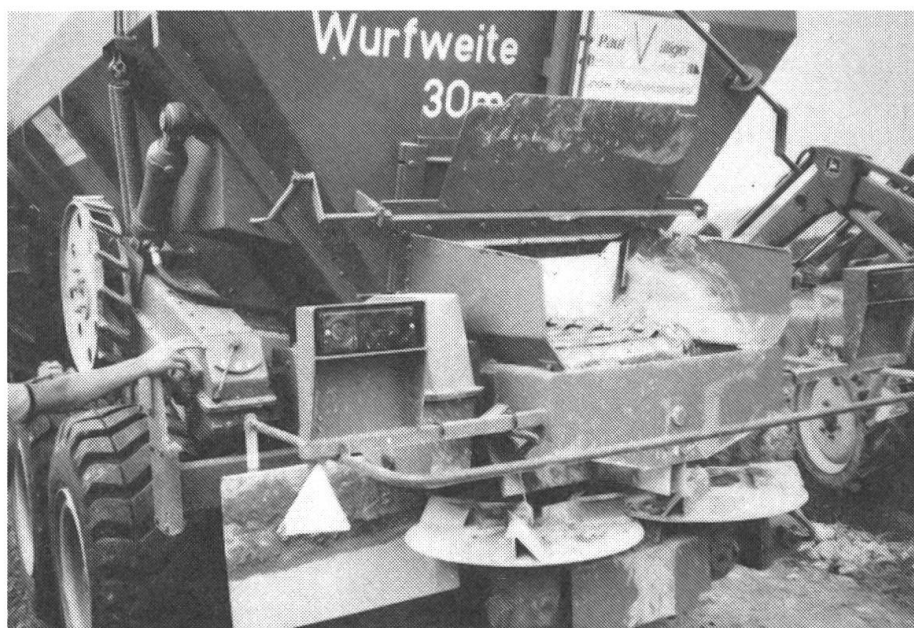
Abb. 3: Der streufähige Klärschlamm wird mittels einer wegeabhängig angetriebenen Stegkette auf das Zweischeibenstreuwerk gebracht und verteilt. Der Antrieb der Stegkette (Reibrad) ist links im Bild sichtbar.
