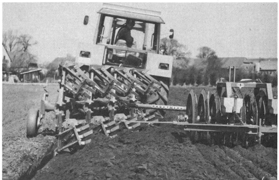
Anbau-Drehpflug, 4-furchig mit Streifenpflugkörper und Untergrundpacker, in Kombination.
