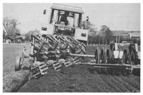
Anbau-Drehpflug, 4-furchig mit Streifenpflugkörper und Untergrundpacker, in Kombination.
