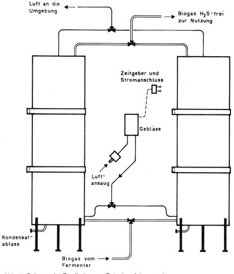
Abb. 1: Schema der Zweikolonnen-Entschwefelungsanlage
