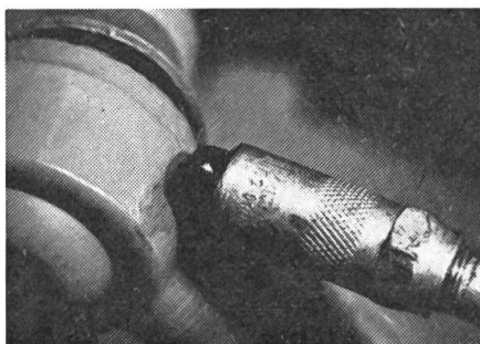
Abb. 4: Schmutziges Fett ist ebenso schlimm wie gar kein Fett. Schmiernippel sind deshalb vor dem Abschmieren mit einem Putzlappen abzuwischen.
