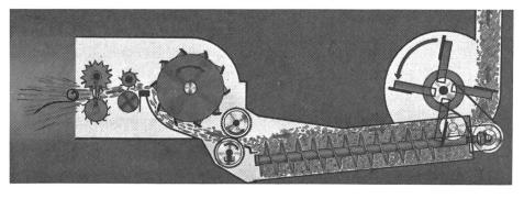
Abb. 3: Der Körnerprozessor sitzt direkt hinter der Messertrommel. Die scharfkantige, geriffelte Oberfläche lässt ganzen Körnern keine Chance.
