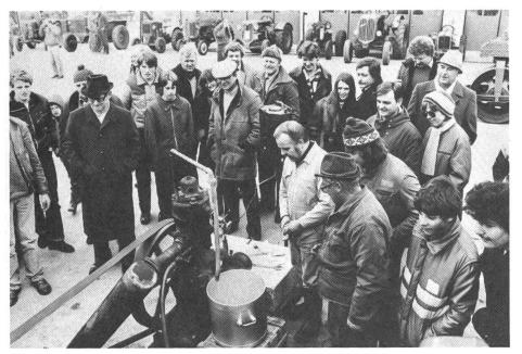
Abb. 2: Der Glükopfmotor fand auch Anwendung als stationäre Antriebsmaschine.
