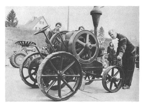
Abb. 1: Ein legendärer Oldtimer, der Lanz-Glühkopfmotor. Das Starten dieses Motors mit der Lötlampe ist Gedulds- und Glückssache.
