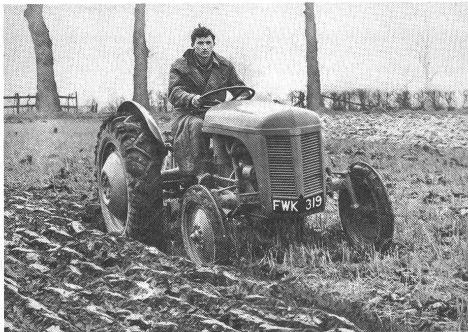
Abb. 5: Das berühmte TE-20-Modell Massey-Ferguson, ursprünglich 23,9 PS, später 28,5 PS, nach 1951 34 PS.
