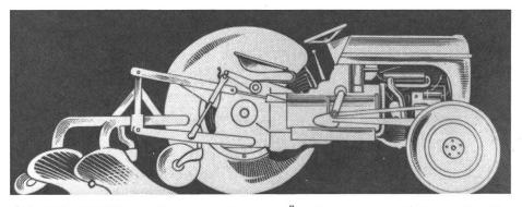
Abb. 2: Das Prinzip des Ferguson-Systems: Übertragung eines Teils des Gerätegewichtes auf die Hinterachse des Traktors.
