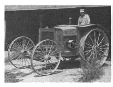
Abb. 3: Erster Massey-Ferguson-Traktor, hergestellt vor 60 Jahren, Modell Massey-Harris No. 1. Angetrieben durch einen quergestellten 4-Zylinder-Benzinmotor, der an der Zapfwelle 12 PS/9 kW und an der Riemenscheibe 25 PS/18 kW leistete.
