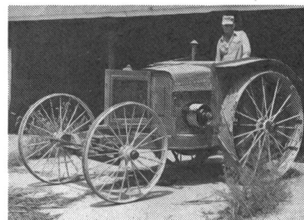
Abb. 3: Erster Massey-Ferguson-Traktor, hergestellt vor 60 Jahren, Modell Massey-Harris No. 1. Angetrieben durch einen quergestellten 4-Zylinder-Benzinmotor, der an der Zapfwelle 12 PS/9 kW und an der Riemenscheibe 25 PS/18 kW leistete.
