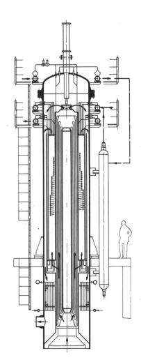
Bild (Sulzer) Prozessgaskühler für Ammoniak-Methanol-Anlagen.
