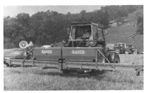
Abb. 4: Sichere und absolut gleichmässige Düngerverteilung von Feldrand zu Feldrand erwartet man vom Breitstreuer mit allen Düngerarten.
