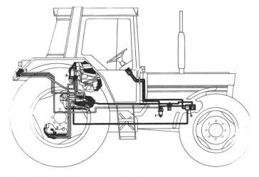
Das Oel zur Steuerung der Sens-o-draulic wird vom Rücklauf (via Nachsaugbehälter (1)) der hydrostatischen Lenkung abgezweigt.
