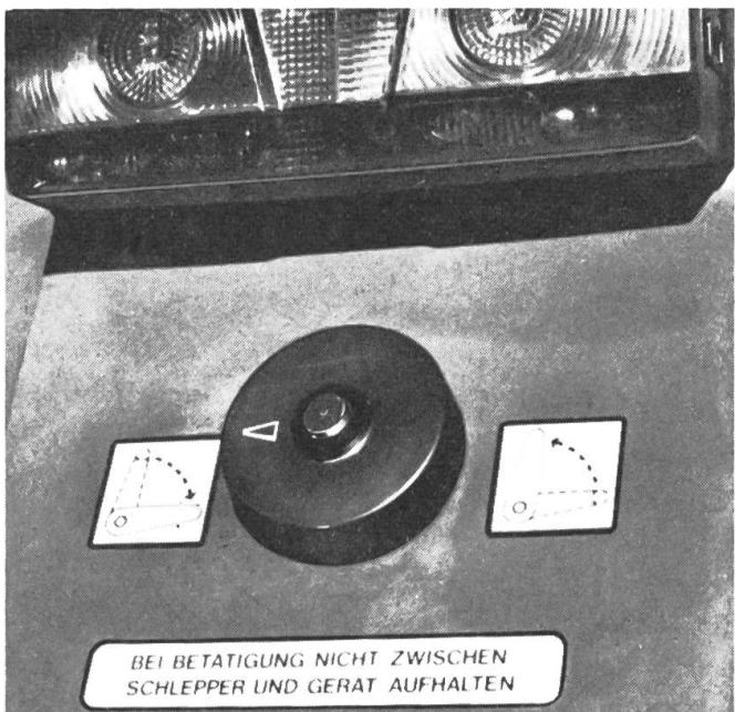
Serienmäßig ist der Drehknopf zum Anheben und Absenken der Unterlenker auf dem rechten hinteren Kotflügel angebracht. Bei dieser bezüglich Arbeitssicherheit vorbildlichen Anordnung wird die Bedienungsperson nicht dazu verleitet oder gar gezwungen, zwischen Gerät und Traktor zu stehen.
