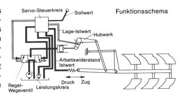
Die aus dem Soll-Ist-Vergleich resultierenden Regelabweichungen bewirken eine Druckdifferenz im Steuerkreislauf, die eine Verschiebung des Hauptsteuerschiebers im Regel-Wegeventil in Richtung Heben oder Senken des Hubwerkes zur Folge hat.
