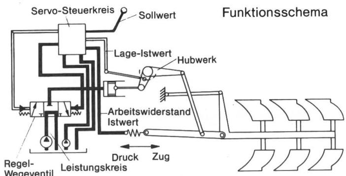
Die aus dem Soll-Ist-Vergleich resultierenden Regelabweichungen bewirken eine Druckdifferenz im Steuerkreislauf, die eine Verschiebung des Hauptsteuerschiebers im Regel-Wegeventil in Richtung Heben oder Senken des Hubwerkes zur Folge hat.
