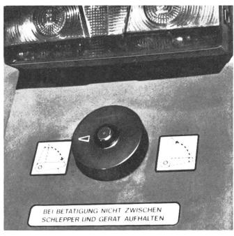
Serienmässig ist der Drehknopf zum Anheben und Absenken der Unterlenker auf dem rechten hinteren Kotflügel angebracht. Bei dieser bezüglich Arbeitssicherheit vorbildlichen Anordnung wird die Bedienungsperson nicht dazu verleitet oder gar gezwungen, zwischen Gerät und Traktor zu stehen.
