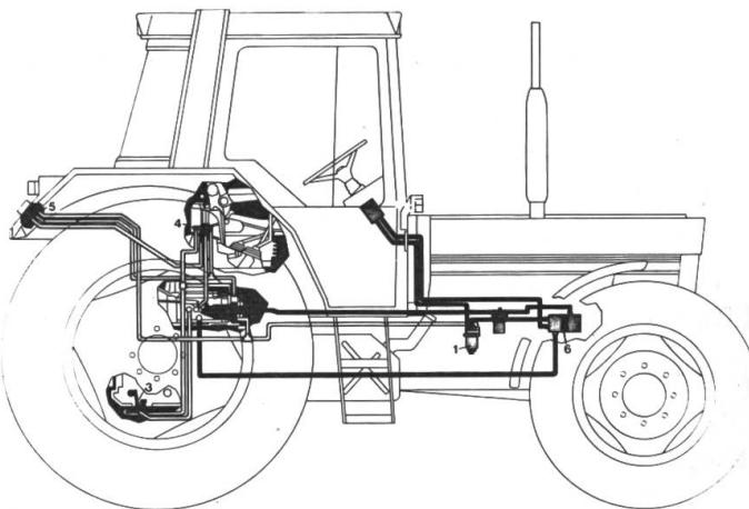
Das Öl zur Steuerung der Sens-o-draulic wird vom Rücklauf (via Nachsaugbehälter (1)) der hydrostatischen Lenkung abgezweigt.
