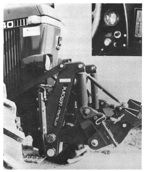
Abb. 1: Durch den Anbau von Front- und Zapfwellenhydraulik wird der Traktor besser ausgenutzt und die Arbeitsleistung gesteigert. Im Bild eine Fronthydraulik mit elektronischer Positionsanzeige (im oberen Bildausschnitt, rechts).
