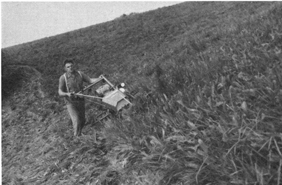
Abb. 5: Mit dem Bergmäher kann noch bis rund 85% Neigung gemäht werden, während die übrigen Erntemaschinen ihre Grenzen spätestens bei 60–65% erreichen.
