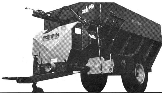
Mit Schnecken- oder Rührflügelmischwelle. Wagentypen von 4 – 12 m<sup>3</sup>.
