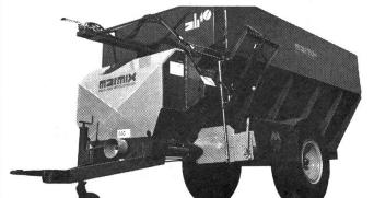
Mit Schnecken- oder Rührflügelmischwelle. Wagentypen von  $4-12 \text{ m}^3$ .
