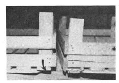
Abb. 11: Durchgedrückte Eckstütze bei einer Holzkiste (rechts). Durch Unterlegen (Pfeil) der untersten Kiste kann die Festigkeit im Stapel stark vergrössert werden.
