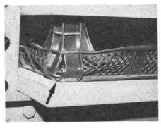
Abb. 9b: Typische Bruchstelle (Pfeil) bei einer Belastung von 2250 kg.
