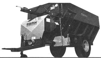
Mit Schnecken- oder Rührflügelmischwelle. Wagentypen von  $4-12 \text{ m}^3$ .
