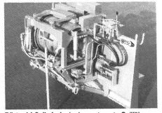
**Bärtschi Seilwinde**, hydr. gesteuerte Seilführung, grosse Seilaufnahme.
