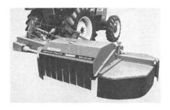
durch wird eine gute Mähqualität erzielt und die Traktorräder fahren nicht über das gemähte und aufbereitete Futter. Für den Einsatz an der Dreipunkt-Hydraulik eignen sich Traktoren ab 50 PS (37 kW).
