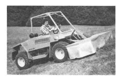
aufweist. Äusserlich hat sich die Maschine nur geringfügig verändert. Neu sind der stärkere KUBOTA-Dieselmotor mit 22,4 kW (30 PS), die hydrostatische Lenkung, eine angepasste Zapfwellen-Kupplung und ein grösseres Zapfwellengetriebe. Das neue Trommelmähwerk hat eine Arbeitsbreite von 190 cm.
