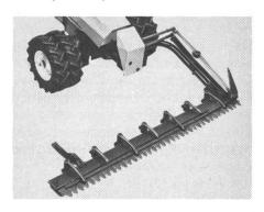
Neben den bewährten Universalund Fingerbalken können die BU-CHER-Motormäher jetzt auch mit diesem neuen BUSATIS-Balken eingesetzt werden. Er arbeitet absolut verstopfungsfrei, und mit seiner Arbeitsbreite von 140 cm ist ein speditives Mähen gewährleistet.
