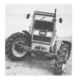
triebswellen. Enorm ist die Hubkraft von 3680 kg der Massey-Fergusson-Hydraulik. Walterscheid Fanghaken, zwei Zusatzsteuergeräte mit 4 Anschlüssen und das Anhängerbremsventil sind Serieausrüstung.
