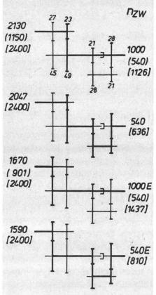
Die Steyr-Vierfach-Zapfwelle ermöglicht, dass die genormte Zapfwellendrehzahl von 540 U/min. zur vollen Leistungsübertragung mit Motornenndrehzahl betrieben werden kann oder bei mittlerem Leistungsbedarf im Teillastbereich oder bei geringer Auslastung nahezu mit Standgas. Ähnliches gilt für die genormte Zapfwellendrehzahl von 1000 U/min.
