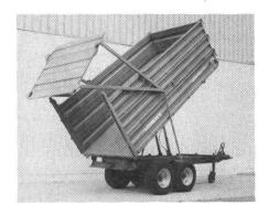
Neu 8-Tonnen-Tandemkipper mit automatisch öffnender Rückwand. Werkfoto der Firma Karl Mengele & Söhne.
