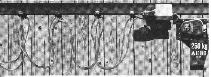
Er reisst 250 kg, entnimmt pro Greifer bis 130 kg Heu, fährt 40 m/min. und hebt und senkt 16 m/min. Er erreicht die hinterste Heustockecke, überwindet Steigungen bis 15° und besitzt ein selbsthemmendes Fahrgetriebe. Vom Heustock aus werden alle Funktionen fernbedient, die Gabel entlädt entweder am Boden oder zu oberst im Anschlag.
