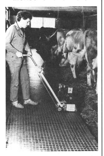
Um die Ausrutschgefahr auf glatten Böden zu verhindern, können diese Oberflächen mit der Von Arx-Flächenbearbeitungs-Maschine FR-200 längs- oder kreuzweise rilliert werden.
