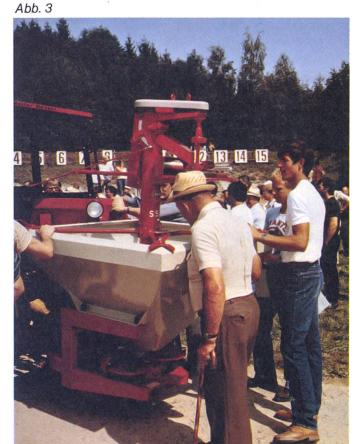
Abb. 4: Grossdüngerstreuer verdecken meistens die Blinklicht- und Beleuchtungsanlage des Traktors. Deshalb ist eine Ersatzbeleuchtung auf dem Anbaugerät dringend vorgeschrieben. Die fehlende schwarz-gelbe Markierung an den Seiten sollte noch vor der Auslieferung an den zukünftigen Kunden angebracht werden.
