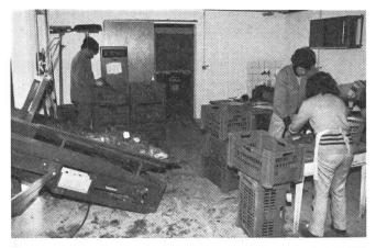
Abb. 3: a) Auswägen, Verlesen und Bonitieren der Rübenproben. b) Nachschneiden der zu hoch geköpften Rüben. c) Waschen und Nettogewichtsbestimmung.
