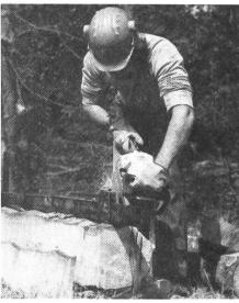
Diese Kettensäge wurde mit Hilfe eines neuen Zusatzgeräts, das auf dem Fällort einfach an die Säge angeschraubt wird, in ein tragbares Sägewerk verwandelt, mit dem sich Bretter, Zaunpfähle und andere nützliche Holzteile herstellen las-
