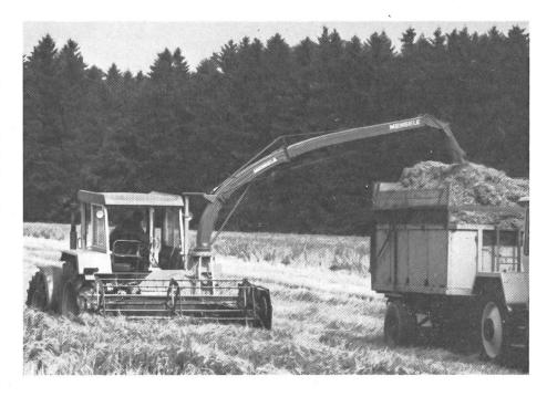
Sämtliche Antriebe (Messerscheibe. Einzugswalzen und Mähscheiben) erfolgen beim neuen Mais-Blitz MB 220 über Gelenkwellen und Ölbadgetriebe. Das bedeutet: Kraftvolle, sichere Häckslertechnik mit minimalem Wartungsaufwand. Bei dieser Konstruktion gibt es weder Ketten noch Keilriemen.
