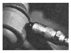
Abb. 4: Schmutziges Fett ist ebenso schlimm wie gar kein Fett. Schmiernippel sind deshalb vor dem Abschmieren mit einem Putzlappen abzuwischen.
