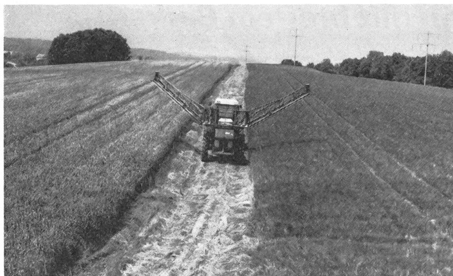
Abb. 2: Die gleiche Maschine beim Feldwechsel ausserhalb der Strasse. Beim Spritzen kann der Balken beidseits nach Belieben dem Gelände angepasst werden.
