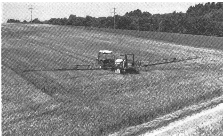
Abb. 3: Der 24 m breite Balken in Arbeitsstellung. Weitere mögliche Arbeitsbreiten sind: 18 oder 12 m.
