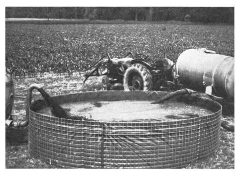
Abb. 5: Mit einem Zwischenlager (Güllebassin) kann die Leistung der Anlage erhöht werden, wenn das Bassin während längerer Zeit und für verschiedene Felder am gleichen Ort stehen gelassen werden kann.
