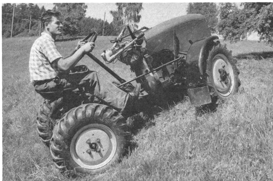
Abb. 5c: Die stersengeführten Einachstraktoren wurden hinsichtlich Gewicht und PS-Leistung teilweise derart «hochgezüchtet», dass sie arbeitstechnisch uninteressant und bald von leichteren Vielwecktraktoren-Typen verdrängt wurden.
