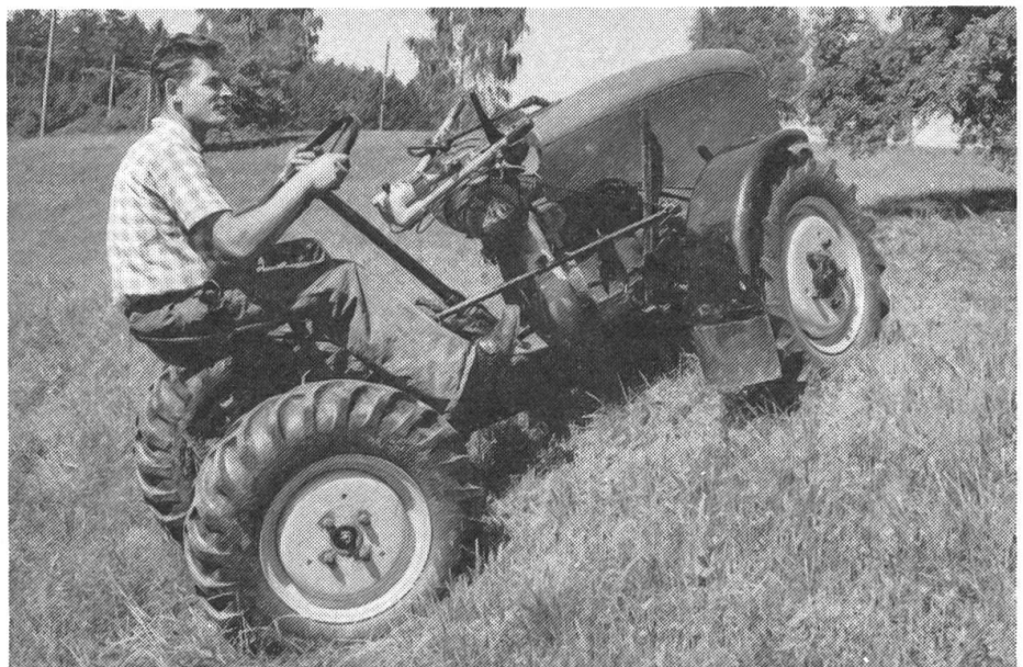
Abb. 5c: Die stersengeführten Einachstraktoren wurden hinsichtlich Gewicht und PS-Leistung teilweise derart «hochgezüchtet», dass sie arbeitstechnisch uninteressant und bald von leichteren Vielzwecktraktoren-Typen verdrängt wurden.
