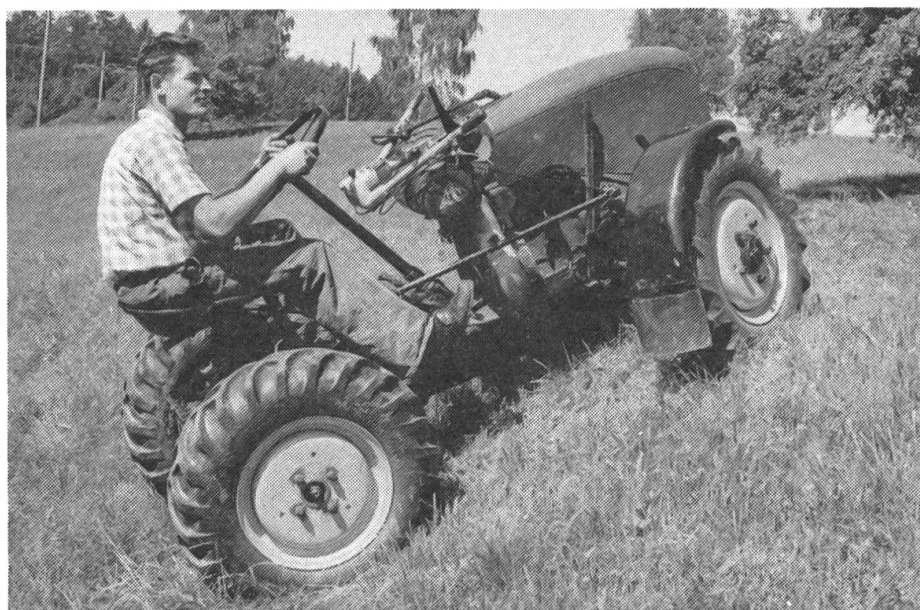
Abb. 5c: Die sterzengeführten Einachstraktoren wurden hinsichtlich Gewicht und PS-Leistung teilweise derart «hochgezüchtet», dass sie arbeitstechnisch uninteressant und bald von leichteren Vielwecktraktoren-Typen verdrängt wurden.
