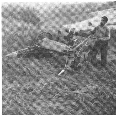
Abb. 3: Motormäher mit Portalachse (günstiger Grasdurchgang) waren in den Trockenjahren 1947 und 1949 sehr begehrt.
