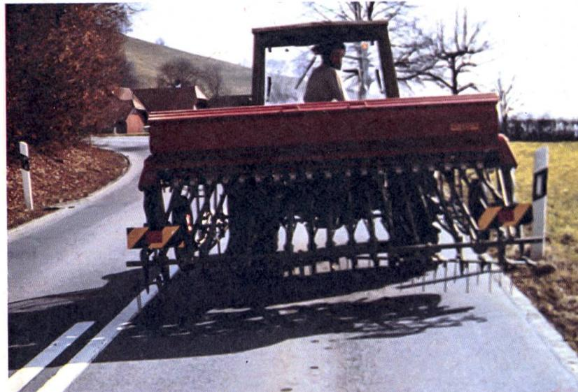
Diese Anbausämaschine ist nur teilweise richtig ausgerüstet. Die schwarz-gelbe Markierung mit den integrierten Rückstrahlern macht auf die Breite der Maschine auf-merksam. Da diese Maschine aber die Blink-Schlusslichtanlage des Traktors gänzlich verdeckt, muss bei Nacht und schlechter Sicht eine entsprechende Er-satzbeleuchtung angebracht werden. Es ist von Vorteil, diese fest an das entsprechen-de Anbaugerät zu montieren.
