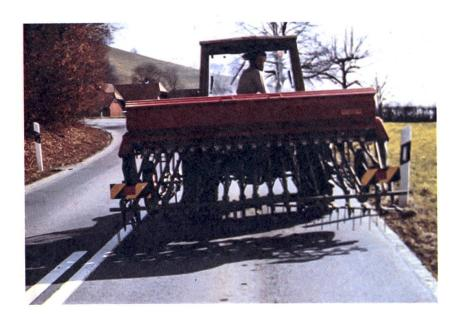
Diese Anbausämaschine ist nur teilweise richtig ausgerüstet. Die schwarz-gelbe Markierung mit den integrierten Rückstrahlern macht auf die Breite der Maschine aufmerksam. Da diese Maschine aber die Blink-Schlusslichtanlage des Traktors gänzlich verdeckt, muss bei Nacht und schlechter Sicht eine entsprechende Ersatzbeleuchtung angebracht werden. Es ist von Vorteil, diese fest an das entsprechende Anbaugerät zu montieren.
