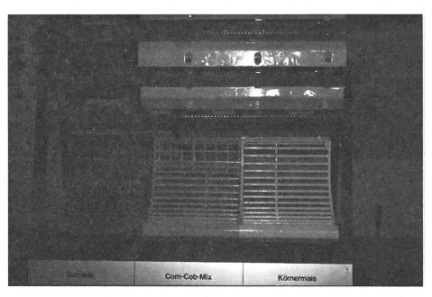
Abb. 2: Für jedes Erntegut ein spezieller Dreschkorb.
