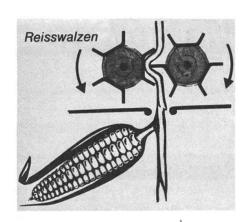
mengen von den Schüttlern ferngehalten, und die Reinigung wird nicht mit Stengelbruchstücken belastet, die von den Sieben nur schlecht ausgeschieden werden. Ausserdem wird die Maschine weniger den sehr korrosiv wirkenden Pflanzensäften ausgesetzt. Dieses Konstruktionsprinzip brachte für den Körnerdrusch den Durchbruch.
