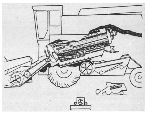
Abb. 4b: Querschnitt eines Axial-Flow-Mähdreschers.
