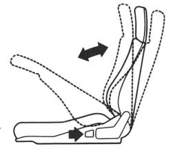
Stufenlose Verstellung der Rückenlehne.
