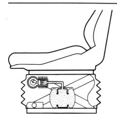
Leistungsstarker Kompressor zur Druckluftversorgung integriert.
