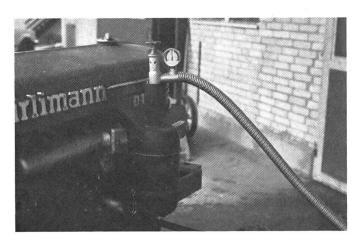
Abb. 3: Das Gerät «Illico» nützt die Saugwirkung am Luftfilter.
