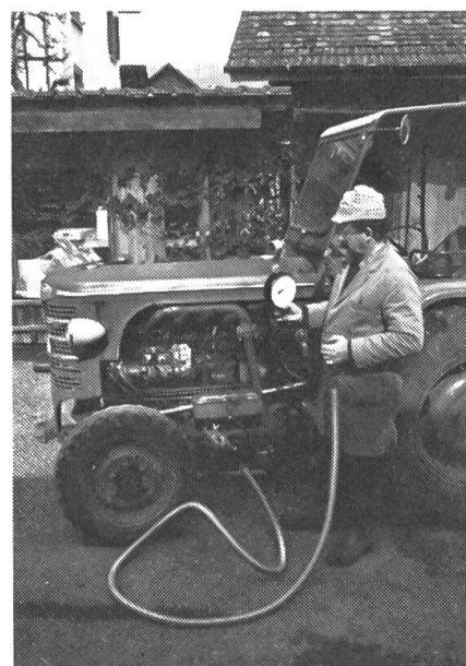
Abb. 4: Kontrolle des Gerätes «Kirpy» beim praktischen Einsatz am Auspuff des Traktors.
