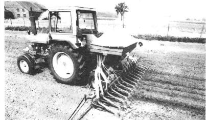
ACCORD Pneumatic Sämaschine einfache Einstellung, Saatmenge von 2 – 360 kg/ha, für Grob- und Feinsaat, höchste Dosiergenauigkeit durch ein Zellenrad, geringe Rüstzeiten, grosse Flächenleistung, Reihen- und Bandsaat (8 cm).
