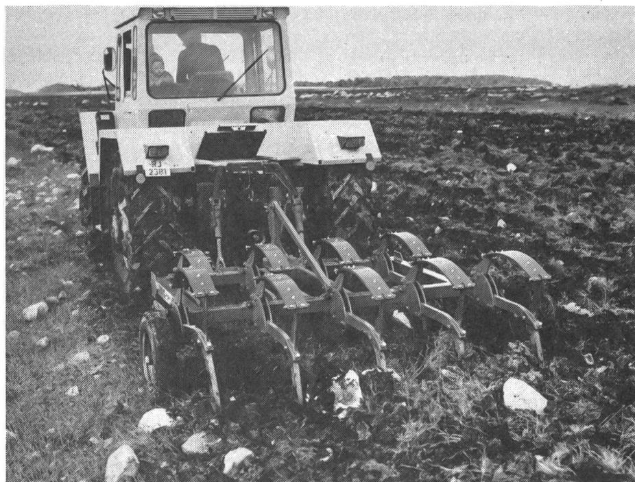
dadurch auch der Einsatz in steinigen Böden problemlos vor sich geht. Die Kverneland-Grubber sind in verschiedenen Arbeitsbreiten mit entsprechender Zinkenzahl lieferbar, mit Arbeitstiefen bis 30 cm oder bis 45 cm. Der einzelne Zinken kann bei Bedarf auch hochgeklappt werden. Luftgummiräder sorgen für exakte Tiefenhaltung.
