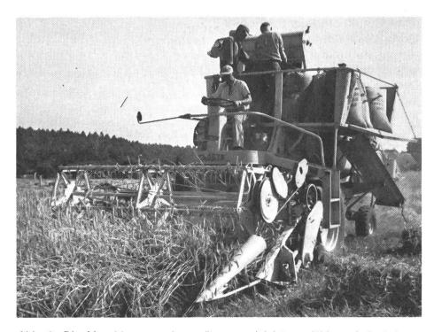
Abb. 2: Die Maschinen wurden grösser und leistungsfähiger, jedoch kaum schöner. Oft wurde bis 12 «Bundessäcke» à 100 kg auf der Plattform mitgeführt.
