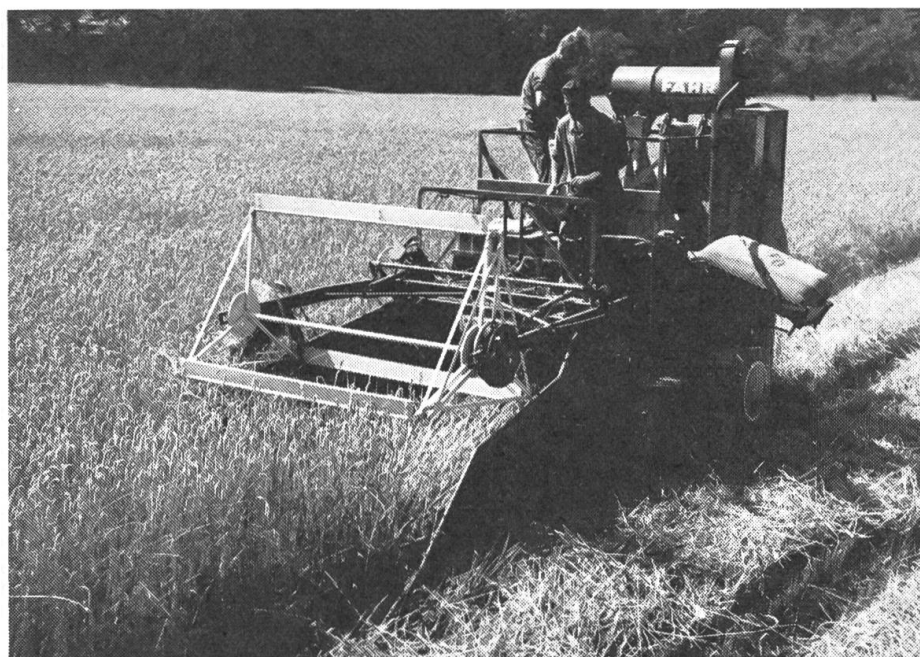
Abb. 1: Aus der Frühgeschichte der Mähdrescherei. Technisch ausgereift war an dieser Maschine nur der seitlich angebaute, damals schon aufgeladene «Hanomag»-Dieselmotor.
