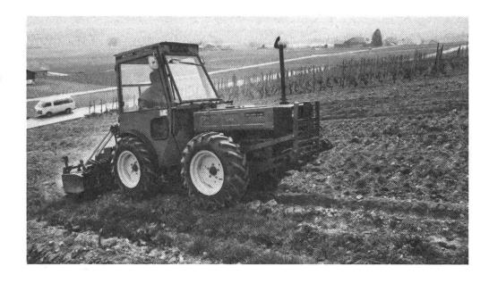
Das **Getriebe** sollte synchronisiert sein und bei 540 U/min an der Zapfwelle im Fahrbereich zwischen 3 bis 8 km/h möglichst viele Gänge (etwa alle 1 km) haben, die einfach zu wählen sind.
