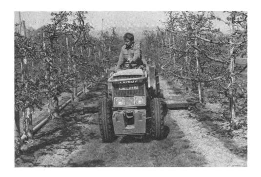
Abb. 1: Kompakt gebaute (schlüpfrige) Schmalspurtraktoren mit Gummikotflügeln, die möglichst bis zum äussersten Rand die Reifen abdecken, ermöglichen eine maximale seitliche Ausladung der Fruchtäste an den Baumkulturen und gewährleisten eine schonungsvolle Bewirtschaftung.
