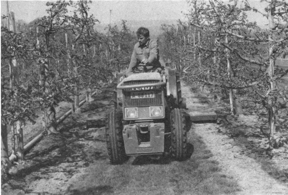
Abb. 1: Kompakt gebaute (schlüpfrige) Schmalspurtraktoren mit Gummikotflügeln, die möglichst bis zum äussersten Rand die Reifen abdecken, ermöglichen eine maximale seitliche Ausladung der Fruchttäste an den Baumkulturen und gewährleisten eine schonungsvolle Bewirtschaftung.
