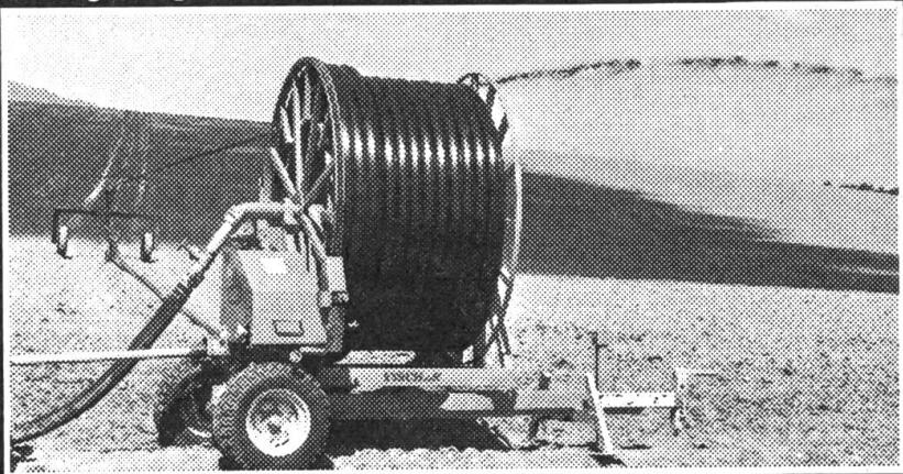
Beregnungsmaschine POLYMAT mit aufgebauter Drehkolbenpumpe zum Ausbringen von Gülle, Klärschlamm und Wasser.
