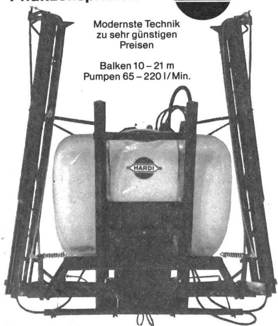
Hydraulische Höhenverstellung. Hydraulisches Zusammenklappen
