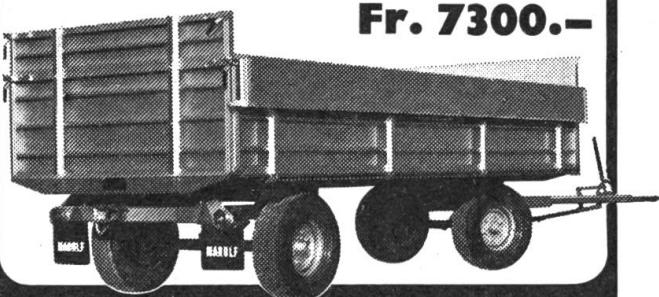
Ein technisch und qualitativ hochstehender Pneuwagen mit einem Ges. Gewicht von 9 Tonnen, Ganzmetallbrücke 500 x 200 cm, Höhe ab Boden 90 cm. ALUMINIUM-Seitenbretter 70 + 30 cm eloxiert, Michelin-Bereifung, 4-Rad-Auflauf- und Fall-Deichselbremse. Gewichtseinsparung durch Verwendung von Alu-Seitenbrettern ca. 130 kg. Der Color 84, leicht, handlich und trotzdem robust.
