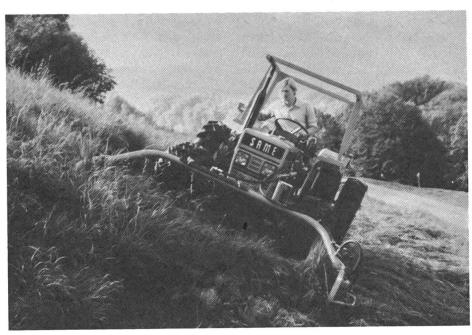
getrieben. Das Mähwerk ist minutenschnell an- und abgebaut, dadurch kann der Traktor vielseitig eingesetzt werden. Die normalisierte 3-Punkt-Hydraulik hat eine Hubkraft von 1200 kg.
