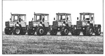
Vom MB-trac 700 bis zum MB-trac 1000 gibt es jetzt die neue Großraumkabine. Mit allem Komfort, der dem Landwirt das Arbeiten erleichtert: Sämtliche Bedienungs- und Schalthebel sind griffgünstig rechts vom Fahrer angeordnet. Hinzu kommen breite Türen, viel Bein- und Kopffreiheit, ein hydraulisch gedämpfter Fahrersitz, aufwendige Geräusch- und Schwingungsdämpfung. Die neue MB-trac-Generation mit dem zukunftsweisenden Allradkonzept und dem geringen Kraftstoffverbrauch erwartet Sie zur Probefahrt.
