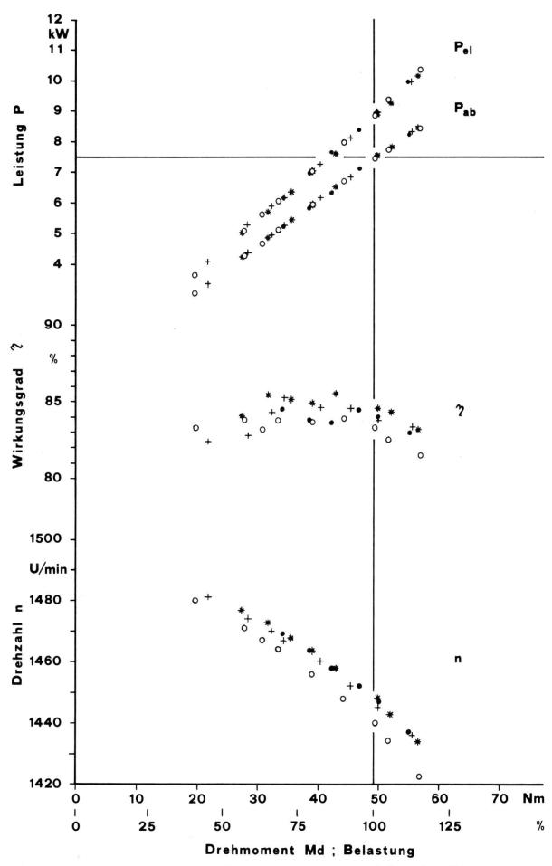
Abb. 1: Aufgenommene elektrische Leistung  $P_{el}$ , abgegebene mechanische Leistung  $P_{ab}$ , Wirkungsgrad  $\eta$  und Drehzahl n in Abhängigkeit der Motorbelastung (Elektromotor Fabrikat A, gemäss Tab. 1; \*+ $\bigcirc$ • Messwerte der vier gemessenen Motoren).
