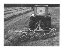
Man nennt den Kuhnflex «Gummischwader», weil er keine Zinken hat, die den Boden berühren, sondern 4 Fördertrommeln mit Gummimanschetten, welche sich dem Boden anpassen. Das Futter kommt bis zur Schwadablage praktisch nicht mehr mit dem Boden in Berührung, das frisch nachwachsende Gras wird geschont.
