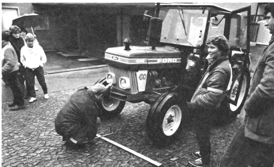
Abb. 1: Genaues Heranfahren an die Stopplinie ist nicht einmal so einfach. Nachgemessen wird mit Senkblei und Meter.
