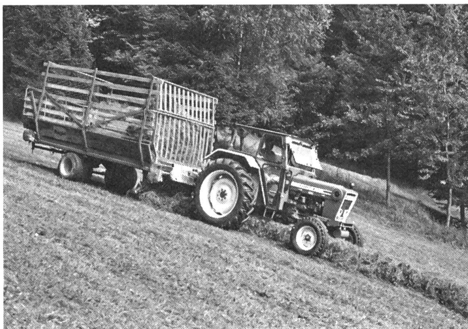
Abb. 4: Die Traktormechanisierung erreicht die Einsatzgrenze bei rund 35% Neigung.
