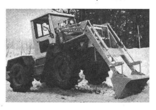
mit Parallelführung und der grossen Auswahl an Arbeitswerkzeugen.
