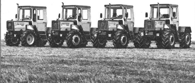
Vom MB-trac 700 bis zum MB-trac 1000 gibt es jetzt die neue Großraumkabine. Mit allem Komfort, der dem Landwirt das Arbeiten erleichtert: Sämtliche Bedienungs- und Schalthebel sind grifffündig rechts vom Fahrer angeordnet. Hinzu kommen breite Türen, viel Bein- und Kopffreiheit, ein hydraulisch gedämpfter Fahrersitz, aufwendige Geräusch- und Schwingungsdämpfung. Die neue MB-trac-Generation mit dem zukunftsweisenden Allradkonzept und dem geringen Kraftstoffverbrauch erwartet Sie zur Probefahrt.
