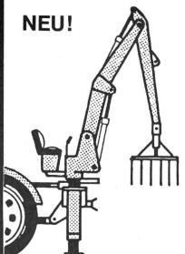
Reichweite 4000 mm. Schwenkbereich nicht 180° sondern 225°, mit schwenkbarem Bedienungssitz. Knicklenkung, keine anfälligen Zahnstangen, komplett zum Aufschrauben auf Transporter .-
