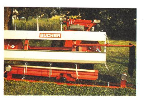
Endlich Frühling! Das erste Mal kann heute Gras gemäht werden. Der Motormäher von Vetter Joggi ist vorbildlich ausgerüstet. Der Balkenschutz mit den daran befestigten Rückstrahlern deckt die gefährlichen Balkenteile ab und signalisiert gleichzeitig die Breite des Mähbalkens. Natürlich hat Vetter Joggi auch das obligatorische Versicherungsschild (Velonummer) eingelöst, ansonsten der Motormäher bei einem Unfall nicht in den Genuss der vorgeschriebenen Haftpflichtversicherung kommt.
