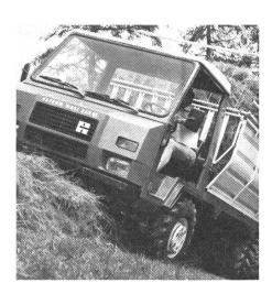
buste Portalbauweise sorgt für optimale Bodenfreiheit und enorme Geländegängigkeit bei tiefer Schwerpunktlage. Servobremsen, hydrostatische Lenkung sowie Allradantrieb und grossdimensionierte Bereifung (11,5/80–15) bürgen für Sicherheit und optimale Fahreigenschaften.
