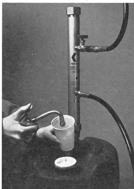
besonderen Schutz sind die materialberührten Teile aus Aluminium, Zink, Chrom, Edelstahl und Nylon, Packungen aus Buna-N Gummi oder Teflon.
