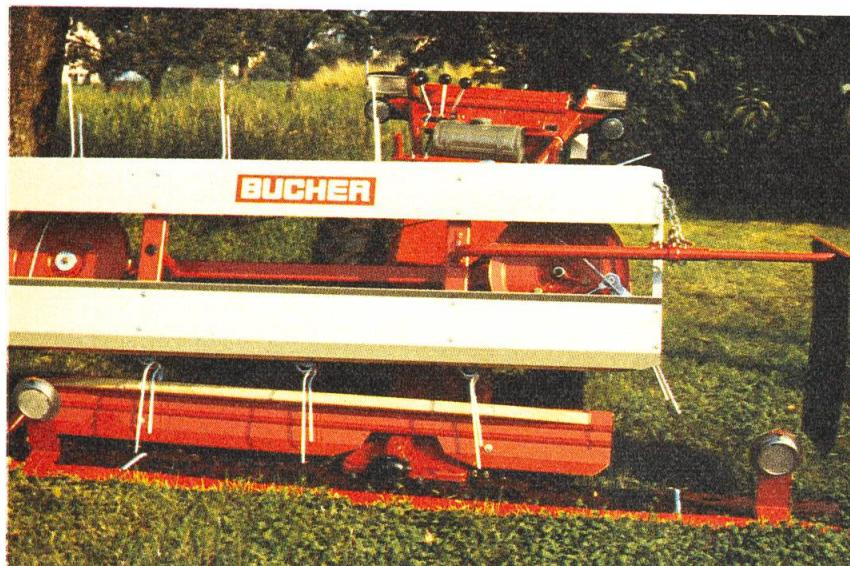
Endlich Frühling! Das erste Mal kann heute Gras gemäht werden. Der Motormäher von Vetter Joggi ist vorbildlich ausgerüstet. Der Balkenschutz mit den daran befestigten Rückstrahlern deckt die gefährlichen Balkenteile ab und signalisiert gleichzeitig die Breite des Mähbalkens. Natürlich hat Vetter Joggi auch das obligatorische Versicherungsschild (Velonummer) eingelöst, ansonsten der Motormäher bei einem Unfall nicht in den Genuss der vorgeschriebenen Haftpflichtversicherung kommt.
