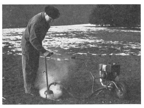
Abb. 3: Ein dichter Rauch sagt nichts aus über die Wirksamkeit der Abgase (Foto: EMPA)
