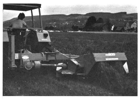
Abb. 2: Mähaufbereiter der neuen «Zweimeterklasse». Die auf mittleren und grossen Futterbaubetrieben häufig vorhandenen Allrad-Traktoren mit einer Zapfwellenleistung von 45–50 kW kommen damit gut zurecht.
