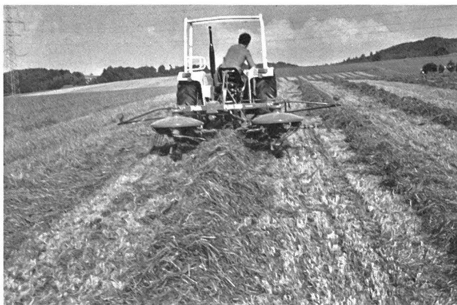
Abb. 3: «Kombiheuer» beim Schwaden. Viele dieser Mehrzweckmaschinen schwaden zur Mitte und können somit nicht beliebig grosse Schwaden machen; sie sind auch zum Freischwaden um Hindernisse weniger geeignet, als seitwärtsschwadende Modelle.
